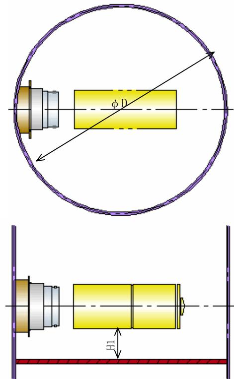
※分割回収時の立坑寸法は2-3 DH-D掘進機構造図内の最小到達寸法を参照ください。
