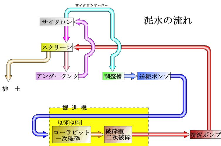
掘削トルク・推進力・蛇行変位等の推進情報は、全て自動計測され、遠隔操作によりリアルタイムに制御しながら推進します。
