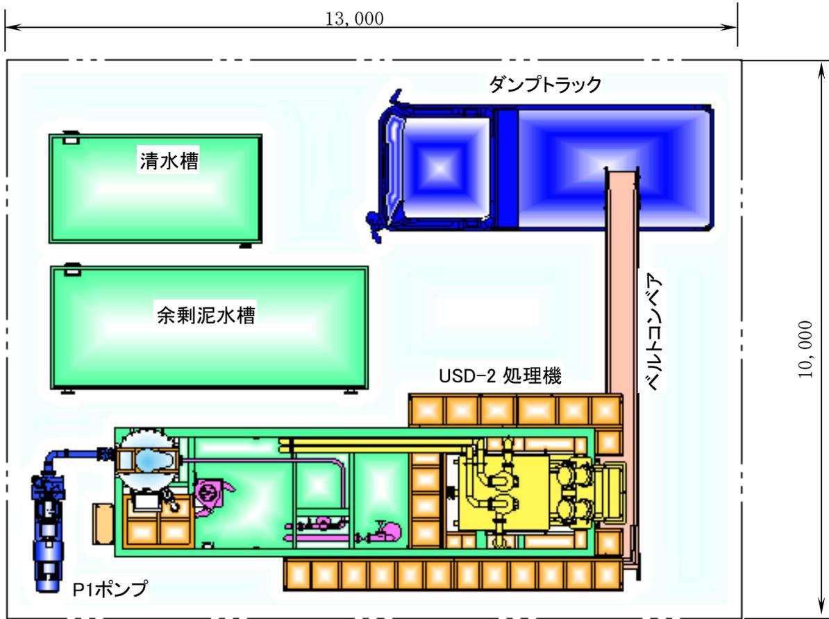
6-2 泥水処理配置図 ( 4 m<sup>3</sup> 仕様)
