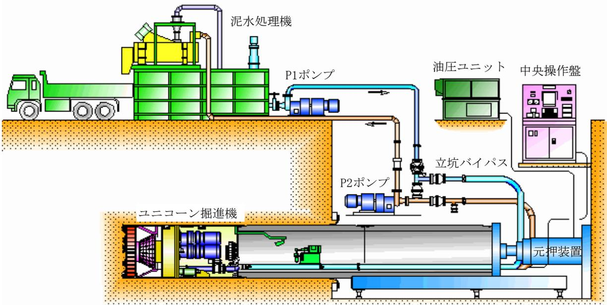
図1-1 ユニコーン工法システム図
